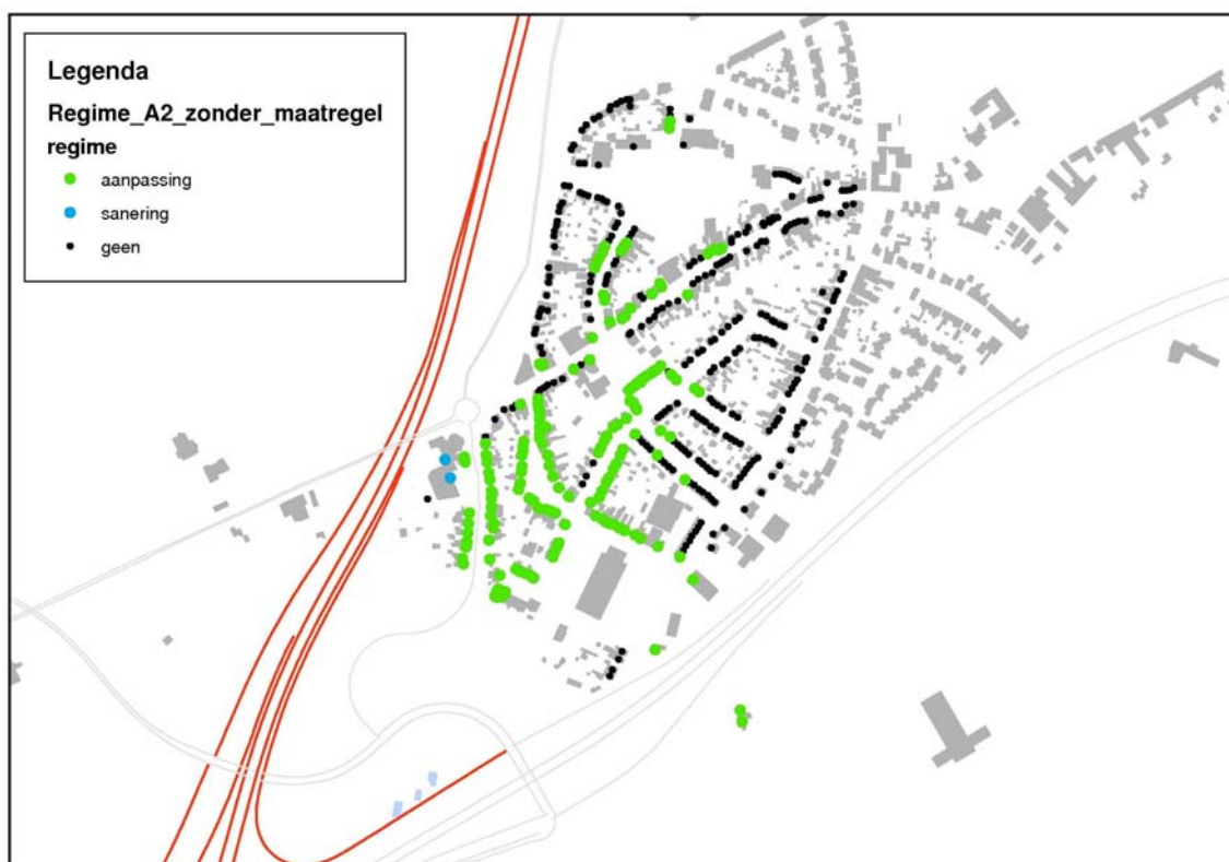
Figuur 5-1 Woningen waar sprake is van sanering of aanpassing ten gevolge van de A2 zonder aanvullende maatregelen.
