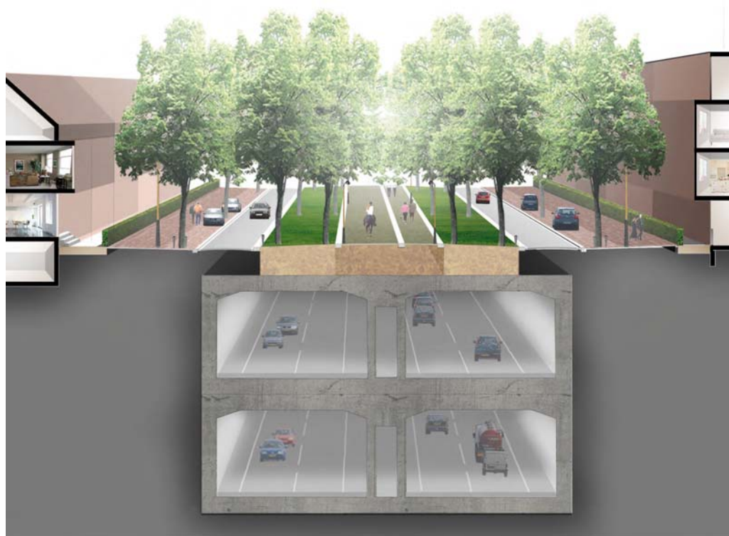
Principedoorsnede over de Parklaan
