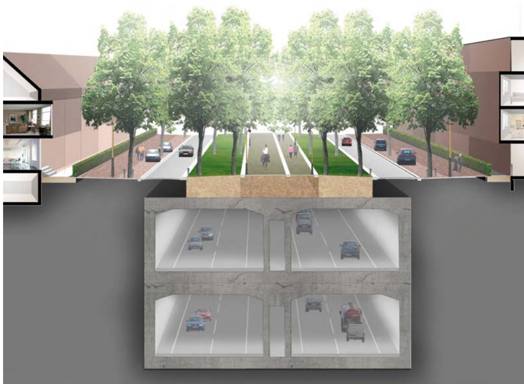
Principedoorsnede gestapelde tunnel onder de Parklaan
