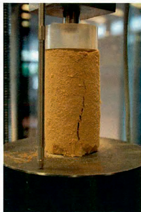
Bild 11: Fotos von „Kalksteen 1“ während des einaxialen Druckversuchs [U 2.1]
