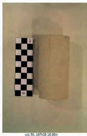
Bild 12: Foto von „Kalksteen 2“ während des einaxialen Druckversuchs [U 2.1]
