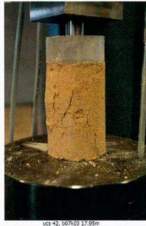
Bild 11: Fotos von „Kalksteen 1“ während des einaxialen Druckversuchs [U 2.1]
