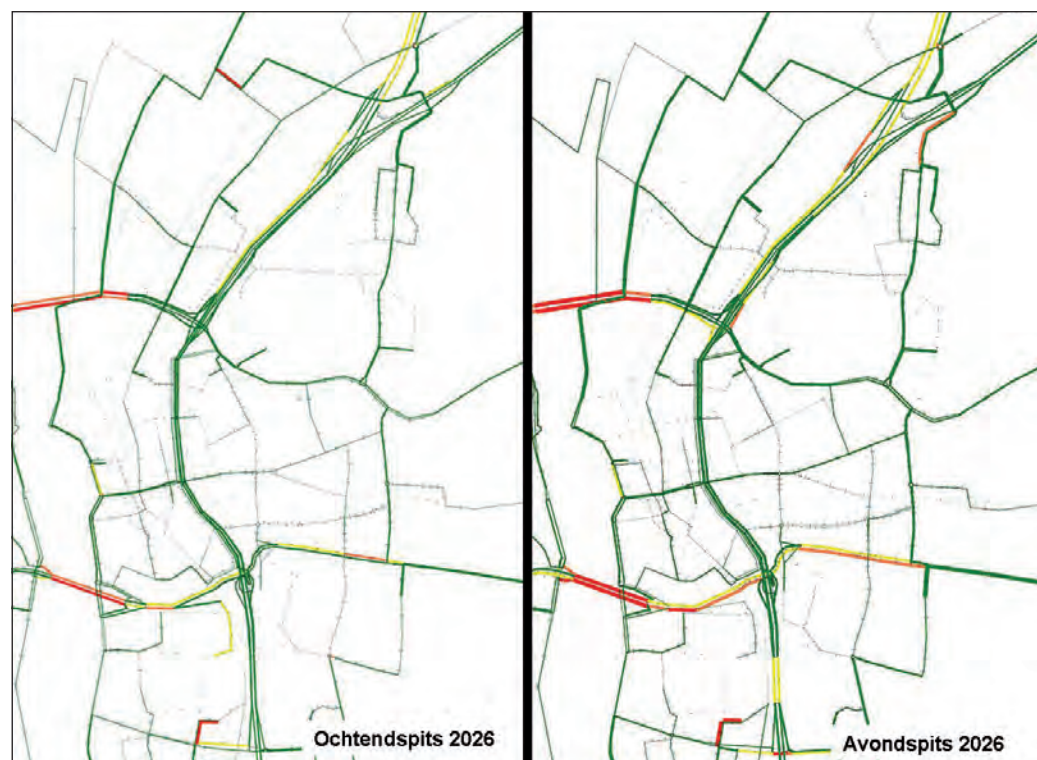
figuur 3.5 Verkeersafwikkeling wegvakken in Maastricht. ochtend- en avondspits, 2026_Avenue2. I/C verhouding: groen: <0.7, geel: 0.7-0.8, oranje: 0.8-1.0, rood: > 1.0. Groen en geel betekenen een goede doorstroming
