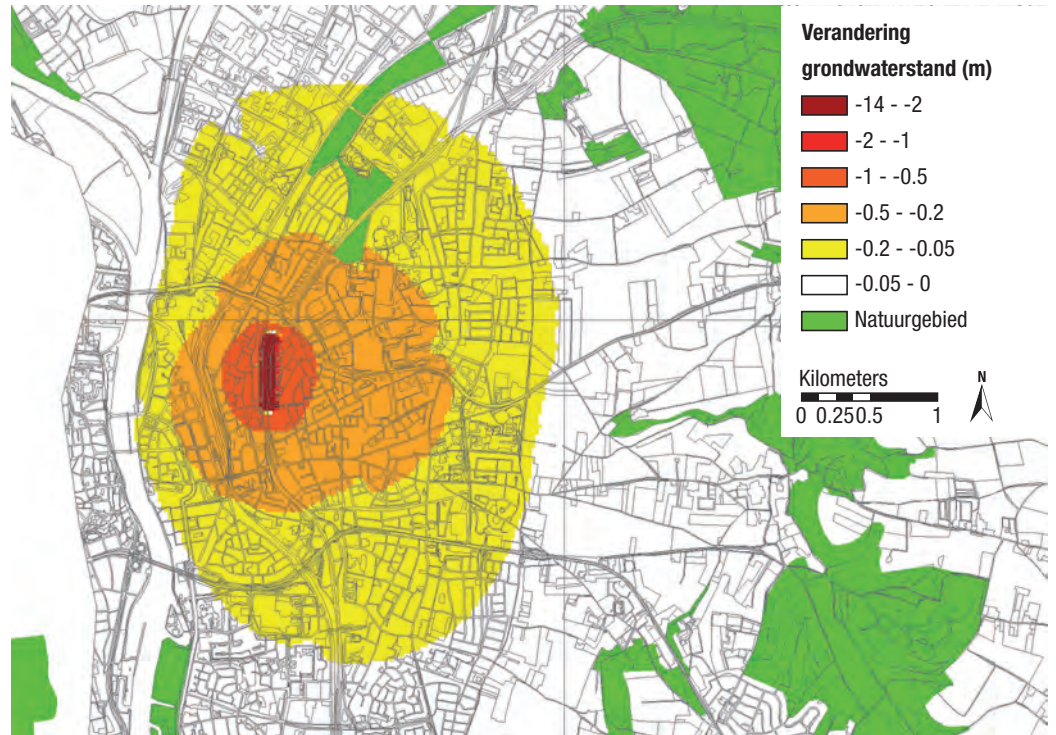
Figuur 4.8 Verandering grondwaterstand na 50 dagen bemaling
