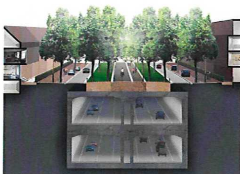
Principe doorsnede dubbelaagstunnel met aan weerszijden nieuwbouw
